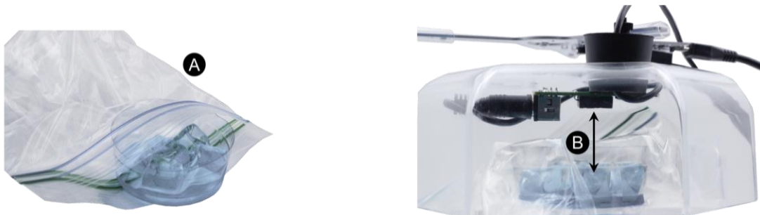
Rysunek 2: Układ chłodzenia umieszczony pod pokrywą
