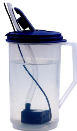
Rysunek 3: Zbiornik na wodę z pompą.
